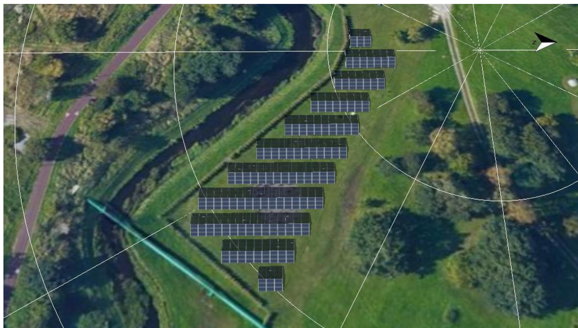
Rysunek 7. Wstępna, koncepcyjna prezentacja zagospodarowania wolnej przestrzeni przez zabudowę elektrowni fotowoltaicznej (Wycinek mapy). Powierzchnia ok. 1609 m 2 ; orientacja wschód-zachód 90°-270°
